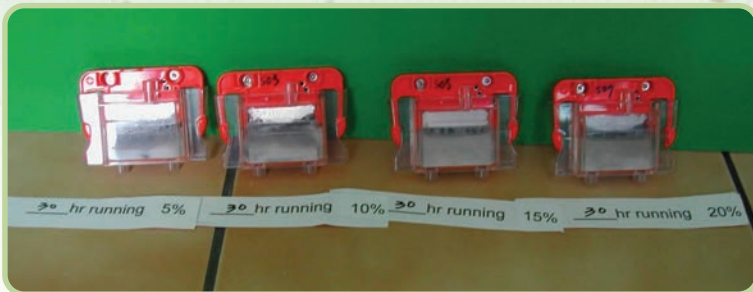
Rys. 7. Zużycie płytki magnezu i wytrącanie się osadu wodorotlenku magnezu
