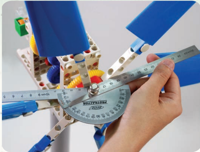
Rys. 40 Aby regulować kąt natarcia każdej z łopatek wykorzystuje się kątomierz.
