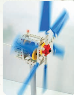
Rys. 41 Aby zmierzyć napięcie na generatorze wykorzystuje się miernik cyfrowy. Przy małych obrotach łopatek, napięcie na generatorze jest niższe niż 1,7 V, dlatego dioda się nie świeci.
